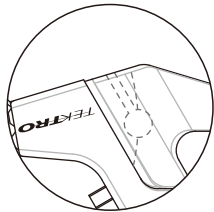
Serie AC Mostrando la ranuras de boquilla superior e inferior (para cantilever y frenos-U)
