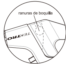
Serie A Mostrando la ranuras de boquilla singular superior (sólo para frenos ESTIRAMIENTO LINEAL-U)
